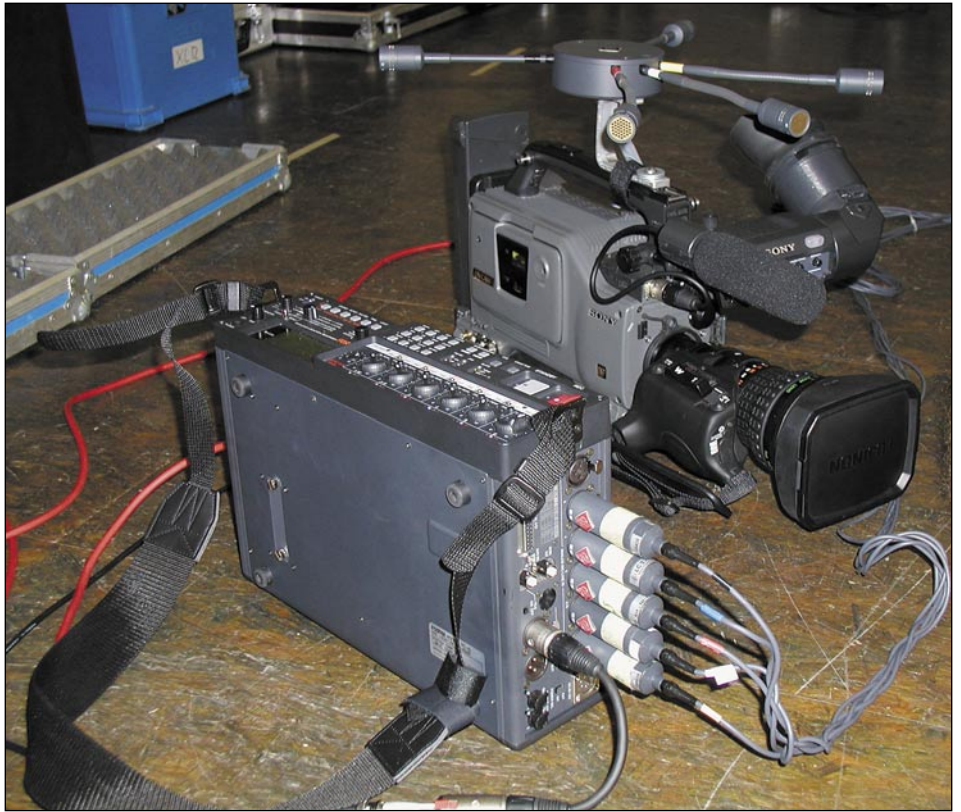
Video-Equipment mit Fostex PD-6 Mehrkanalrecorder und Neumann WMS-100-Surround-Spinne auf der Kamera
